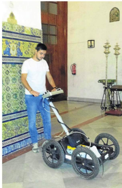
A la izquierda, el georadar que analiza el subsuelo de los templos. A la derecha, recogida de información.
