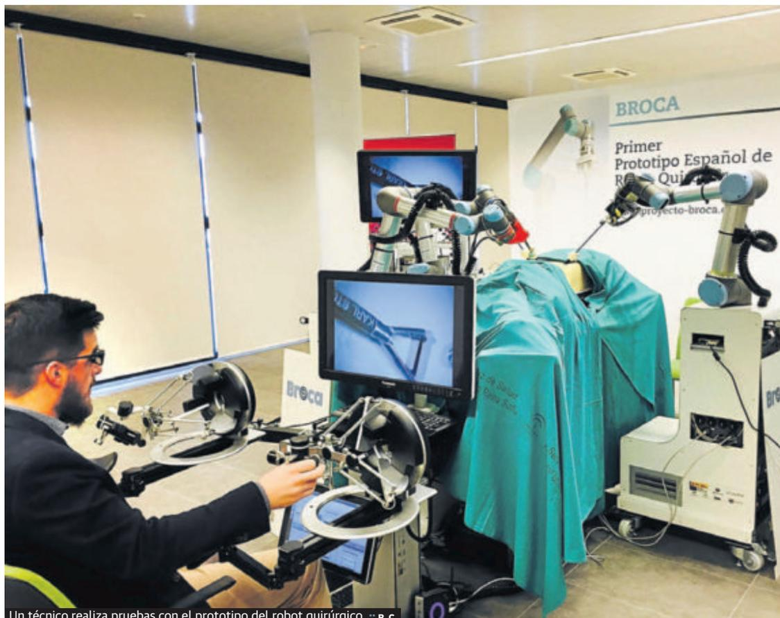
Un técnico realiza pruebas con el prototipo del robot quirúrgico. :: R. C.
