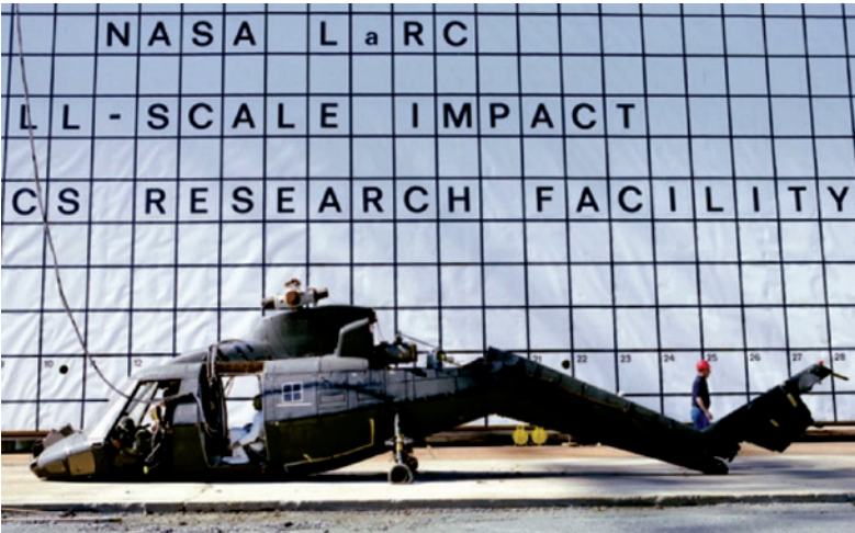
Figura 32. Impacto desde torre de caída de helicóptero Apache fabricado completamente en material compuesto de fibra de carbono
