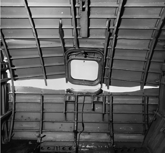
Figura 23. Aspecto, desde el interior del avión, de la rotura en el avión Comet ensayado en Farnborough, originada a partir de una esquina de una puerta
