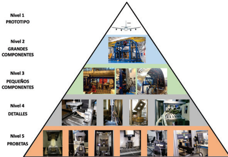
Figura 31. Pirámide de ensayos usada en la industria aeronáutica, ilustrada con ejemplos desarrollados en el GERM
