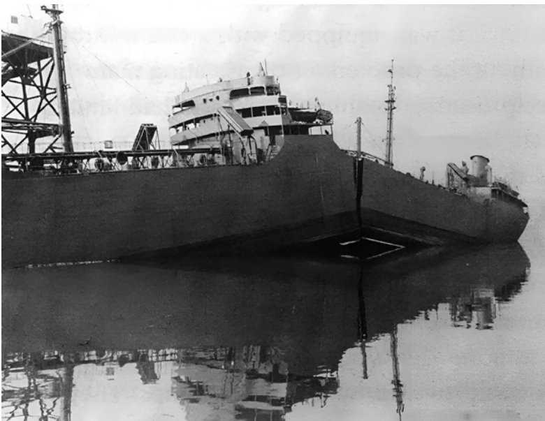
Figura 20. Imagen de un barco Liberty con rotura catastrófica
